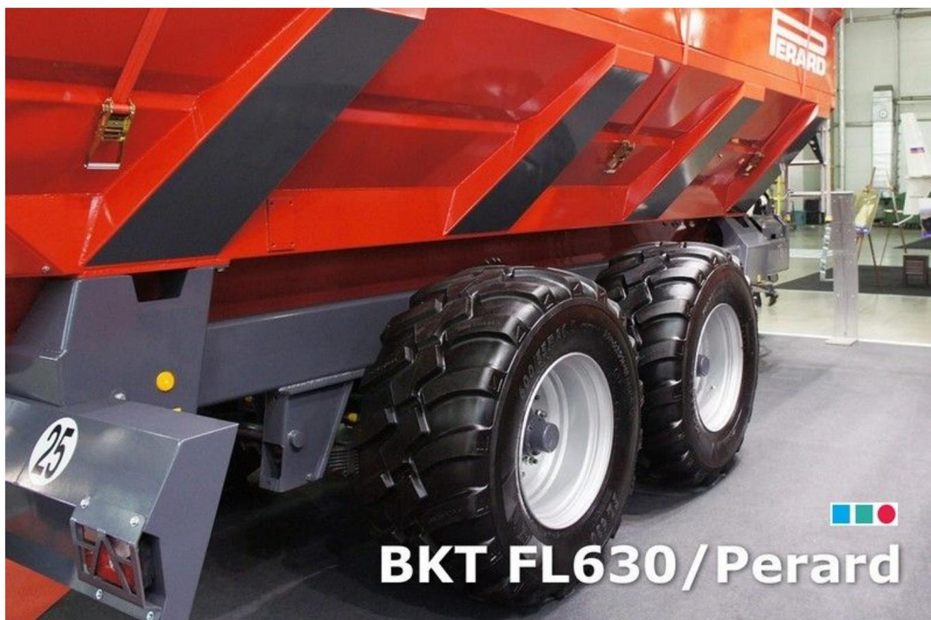
Радиальная шина флотационного и транспортного типа
