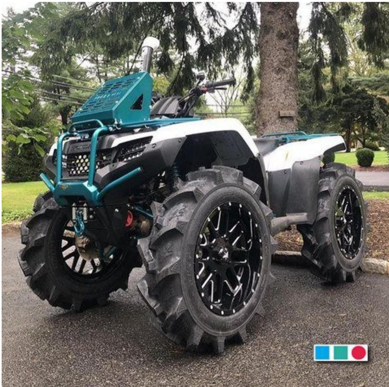
Благодаря выдающимся свойствам самоочистения эти шины идеально подходят для эксплуатации на влажной и сырой почве. Даже в самых сложных условиях работы шины TR 171 гарантируют превосходную тягу и непревзойденную долговечность.
